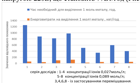
Рис. 1 Порівняльна характеристика ефективності катодного виділення металів.
