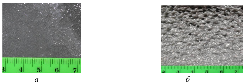
Рис. 5. Вплив товщини плівки на якість її внутрішньої поверхні ГЕМА:ПВП:Н 2 О = 7:3:10 мас.ч., [Zn] = 20 % мас.; n=700 об/хв: а – 1 мм, б – 4 мм
