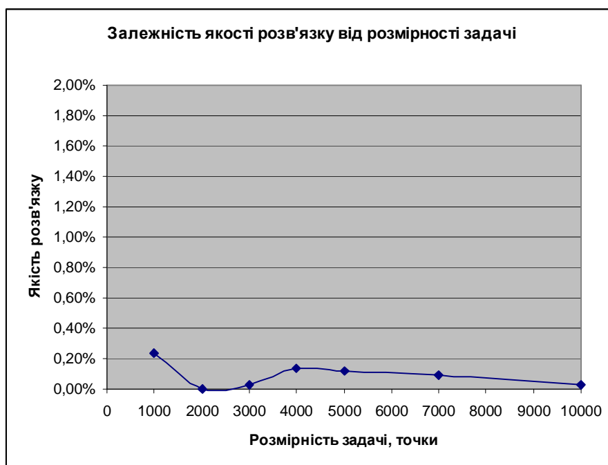
Рис. 9. Залежність якості розв'язку від розмірності задачі для декомпозиційного алгоритму
