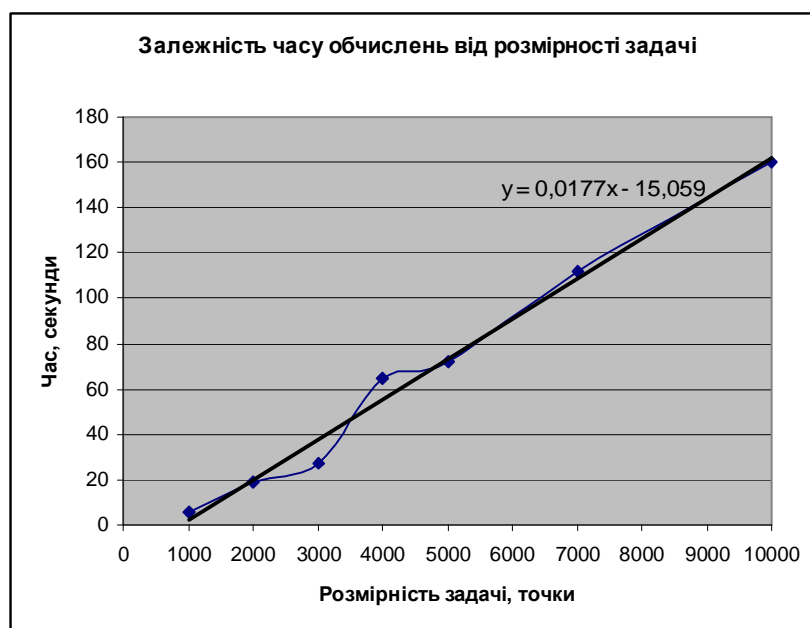
Рис. 8. Залежність часу обчислень від розмірності задачі для декомпозиційного алгоритму
