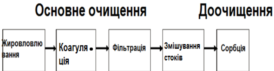
Рис. 1. Схема очищення стічних вод технологічних ліній виробництва
