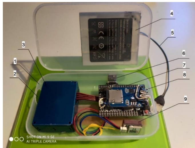
Рис. 4. Прилад реєстрації концентрації РМ аерозолі. Розташування модулів та датчиків: 1 – корпус, 2 – отвір для доступу повітря, що досліджується, 3 – датчик концентрації РМ, 4 – зовнішній акумулятор, 5 – кабель живлення, 6 – плата датчиків температури, вологості та тиску (знаходиться назовні корпусу), 7 – плата мікроконтролера, 8 – модуль SD-карти, 9 – модуль GPS.
