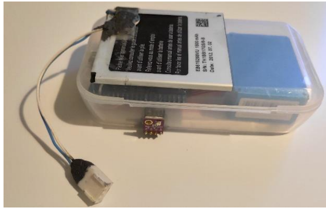
Рис. 3. Загальний вигляд приладу реєстрації концентрації аерозолі РМ з зовнішнім акумулятором.
