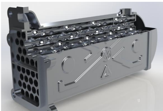
Рис. 1. Комп'ютерна модель теплообмінника EGR в розрізі
