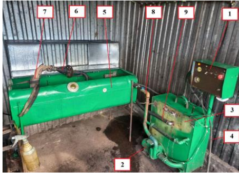
Рис. 1. Установка для хімічного очищення сажових фільтрів: 1 – панель керування; 2 – водяний насос; 3 – резервуар з водою; 4 – підвід стисненого повітря; 5 – мийна камера; 6 – перехідна насадка; 7 – сажовий фільтр; 8 – напірна магістраль; 9 – зворотня магістраль.
