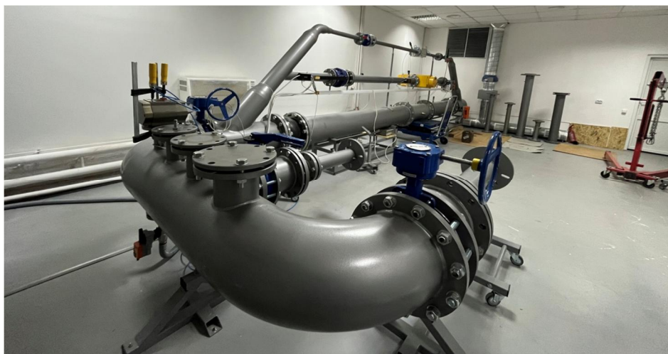
Рис. 1 Еталонна установка для проведення повірки лічильників газу в діапазоні об'ємної витрати газу від 0,1 м 3 /год до 6500 м 3 /год
