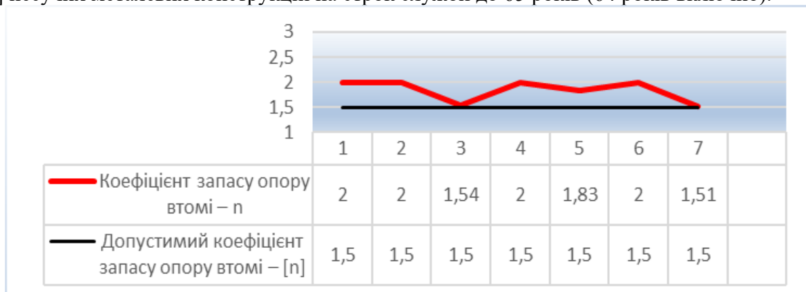
Рисунок 1 – Графік порівняння отриманих та допустимих значень коефіцієнту опору втомі
