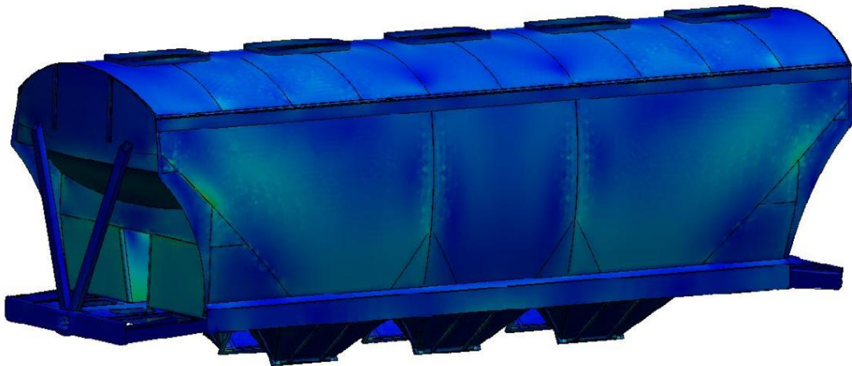
Рис. 2 Епюра напружень за III режимом (розтяг)
