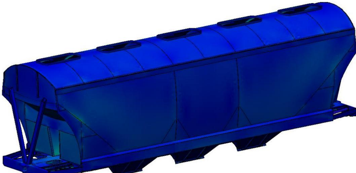
Рис. 1 Епюра напружень за I режимом (розтяг)
