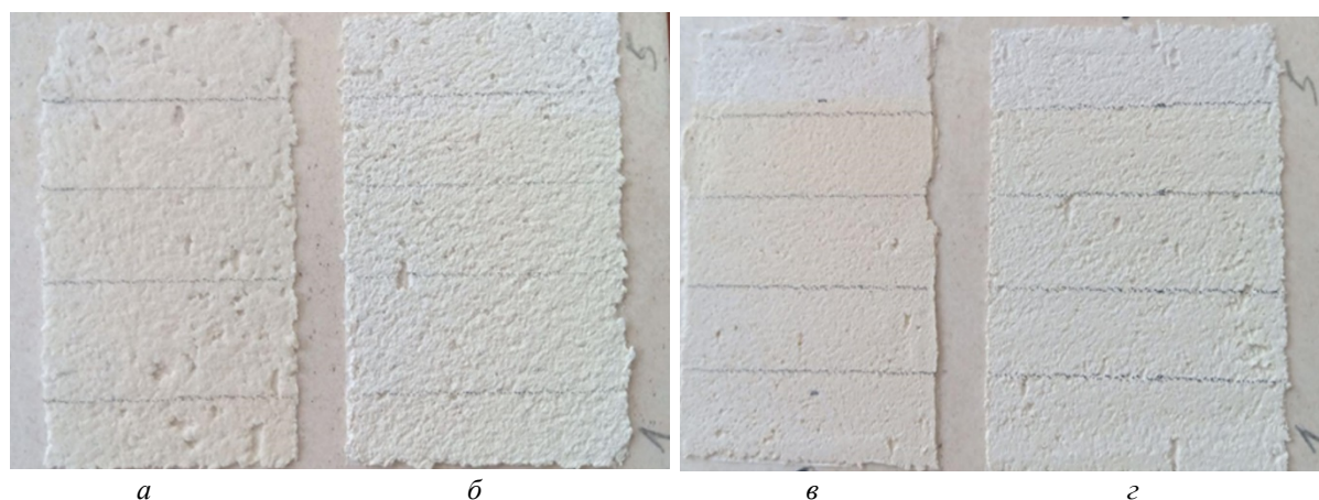
Рис. 1. Зміна кольорового тону зразків у процесі опромінення УФ-лампю: а – з волокнами Arbocel BC400; б – з волокнами Arbocel BC400 і додаванням оксиду титану; в – з волокнами технічної целюлози; г – з волокнами технічної целюлози і додаванням оксиду титану
