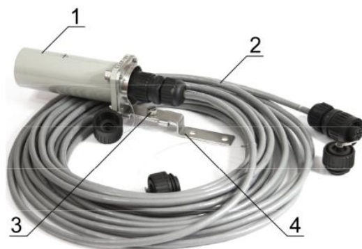
Рис. 1. Блок детектування гама-випромінення БДБГ-09 1 – детектор, 2 – з'єднувальний кабель, 3 – кронштейн, 4 – фіксатор
