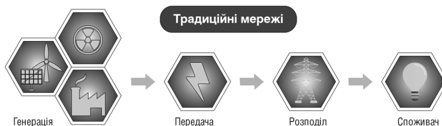
Рис. 1. Структура виробництва та розподілу енергії у традиційних мережах
