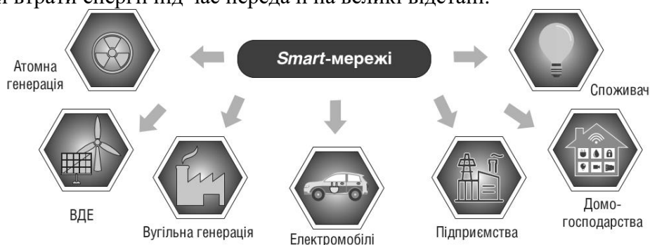
Рис. 2. Структура виробництва та розподілу енергії у smart-мережах
