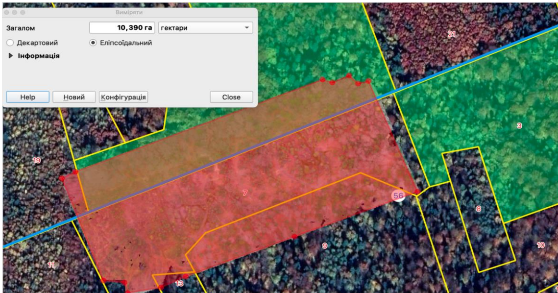
Рис. 4. Фрагмент обрахунку площі місцевості за ортофотопланом та уточнення межі невтручання у пралісову ділянку з використанням програми QGIS
