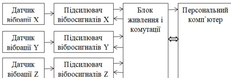
Рисунок 1. Структурна схема ПАК.
