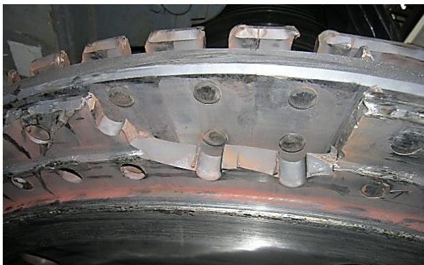
Рис. 1. Загальний вигляд пошкодженого диску ротора високого тиску турбіни та фрагментів заклепок в центральному гребені диску
