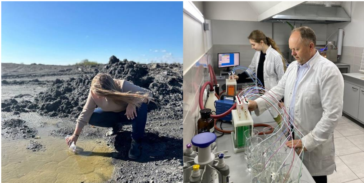
Рис. 2. Відбір та підготовка проб стічних вод у межах об'єкту дослідження
