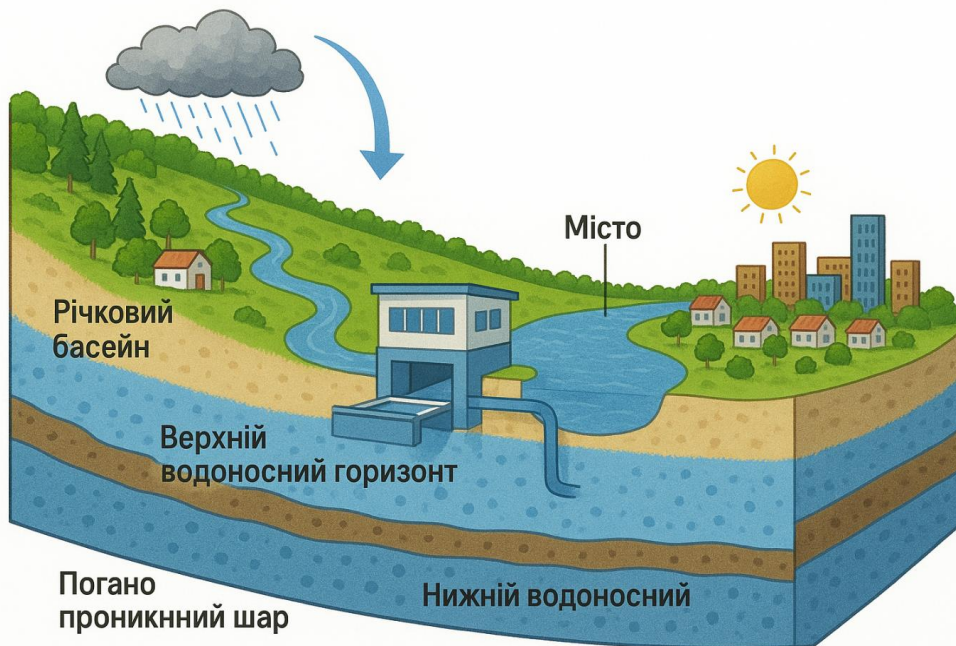
Рис. 1. Схематична будова річкового басейну з водозабірною станцією
