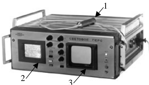
Рис. 2. Напівавтомат ручного вводу характерних особливостей зображень: 1 – світлове перо на базі ФЕП 2 – “дисплей” на запам’ятовувальній ЕПТ; 3 – слідкувальна ЕПТ
