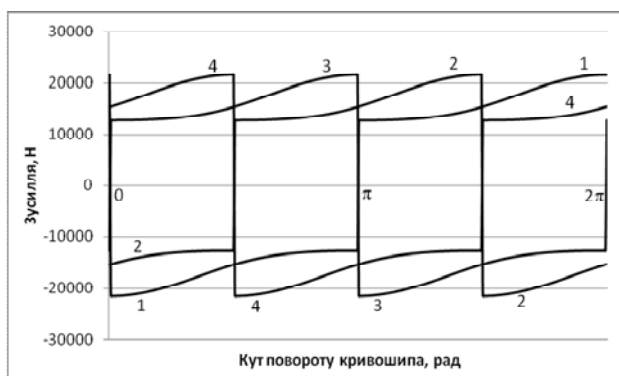
Рис. 3. Графіки зміни зусиль у шатунах: F_1 – 1, F_2 – 2, F_3 – 3 та F_4 – 4 залежно від кута повороту кривошипа
