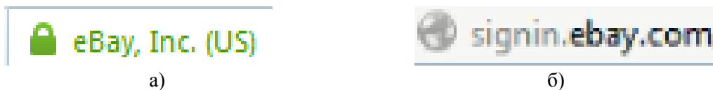
Рис. 3. Демонстрація різниці захищеним оригінальним з'єднанням (а) та з'єднанням, яке створене зловмисником (б).
