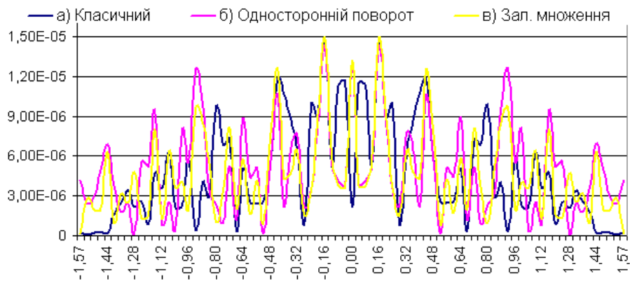
Рис.2. Модуль похибки обчислення функції \sin(x)
