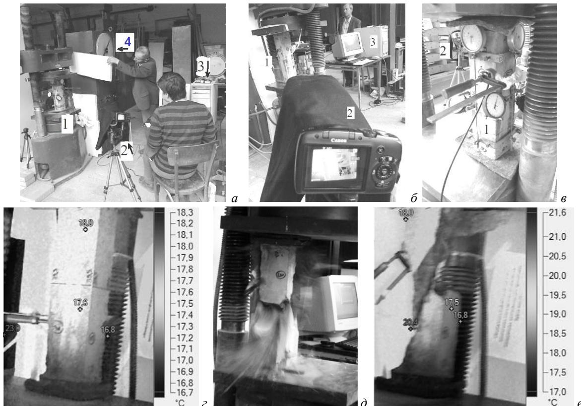
Рис. 4. Випробування призми П-2. а – загальний вигляд випробування (1 – прес з призмою, 2 – тепловізор з реєстратором відео, 3 – ПК «АКЕМ», 4-шкала пресу), б – відеозапис тепловізора, в – вигляд призми з мікроіндикаторами (5) та датчиком АЕ (6), г – вигляд розподілу температурного поля в момент перед руйнуванням, д – момент руйнування призми.
