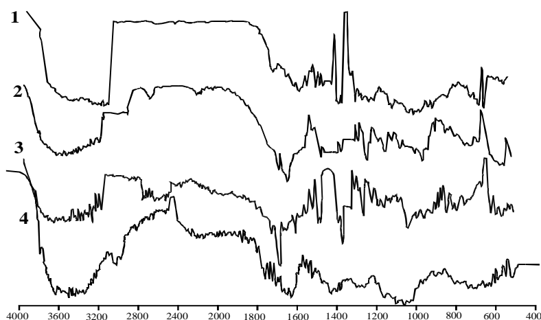
Рис. 8. ІЧ-спектри вихідної ксантанової камеді (1) та (ксантанова камедь)-графт-полівінілпіролідон (2), (ксантанова камедь)-графт-полі(вінілацетат-ко-малеїновий ангідрид) (3) та (ксантанова камедь)-графт-полібутілакрилат (4)
