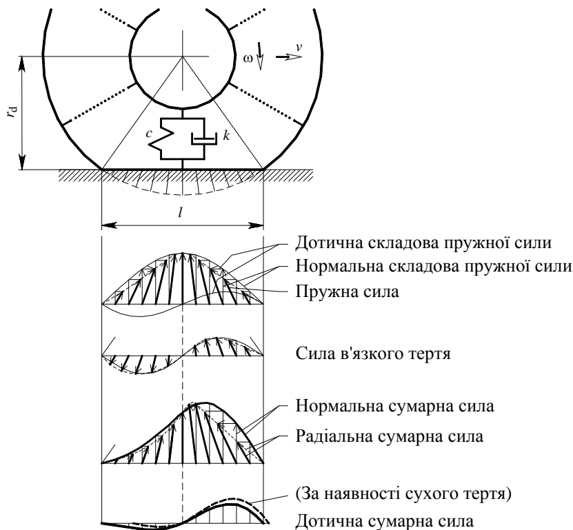
Рис. 6. Схема виникнення несиметричності у розподілі сил у сліді колеса і несиметричності у деформаціях шини унаслідок прояву внутрішнього в'язкого тертя
