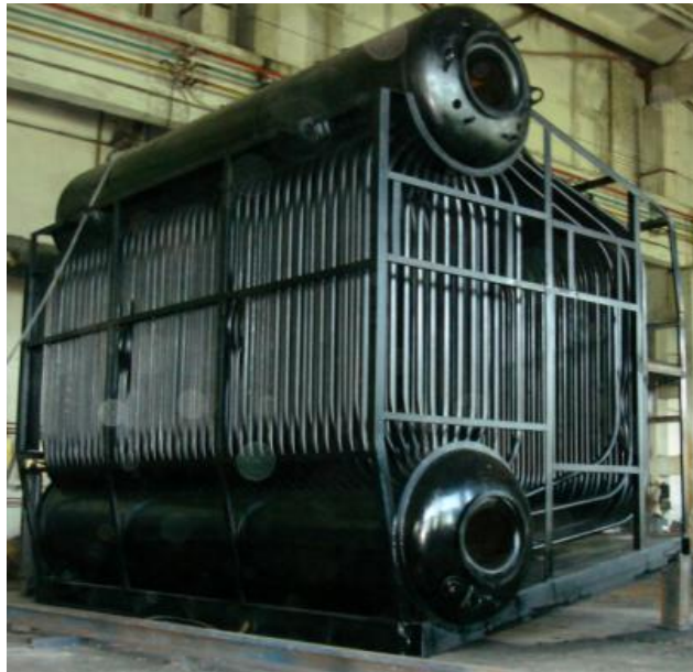
Рис. 1. Загальний вигляд котла ДЕ-10-14ГМ
