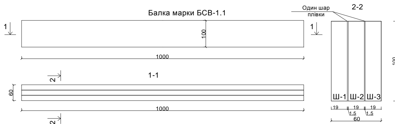
Рис. 1. Зразок скляної багатошарової балки, де Ш-1,2,3 – нумерація шарів скла
