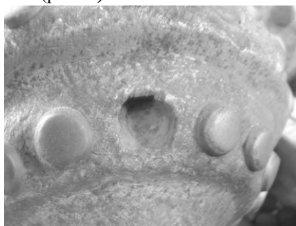
Застосування сталі 16ХНЗМА для шарошок дало до 3% сколювання породоруйнівного оснащення, мало місце розхитування та випадання зубків [2]. Інший характер руйнування вставного породоруйнівного оснащення зафіксовано на шарошках зі сталі 20ХНЗА і 17НЗМА. Тут переважно зубки випадали через високу жорсткість в системі „шарошка-зубок-вибій” зумовленою нижчою границею плинності таких марок сталей (рис. 3).
