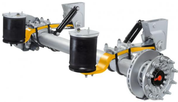
Рис. 1. Підвіска напівпричепи автомобіля з півресорою SAF Modul
