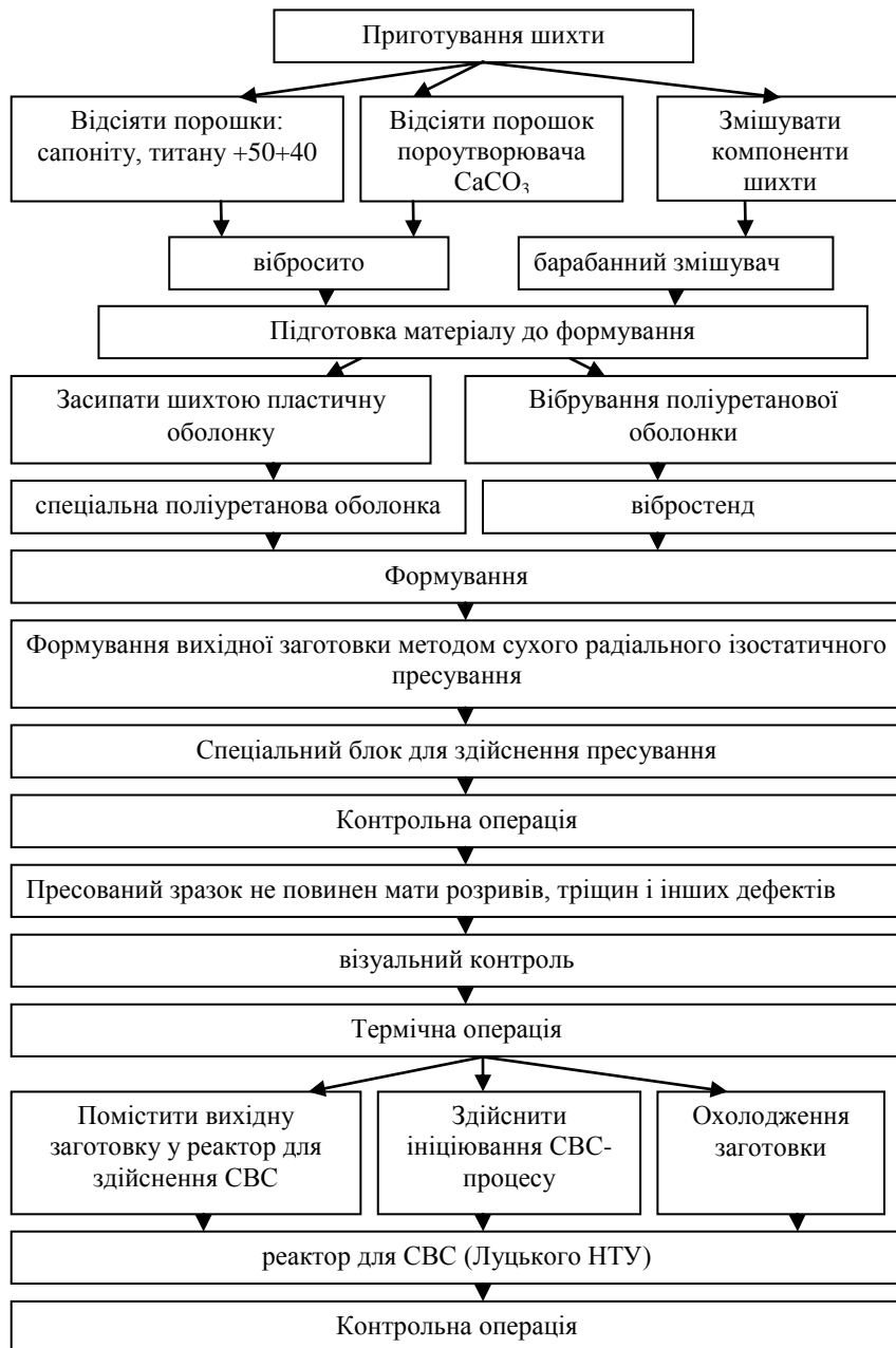
Рис. 2 – Технологічна схема методу СВС Луцького НТУ
