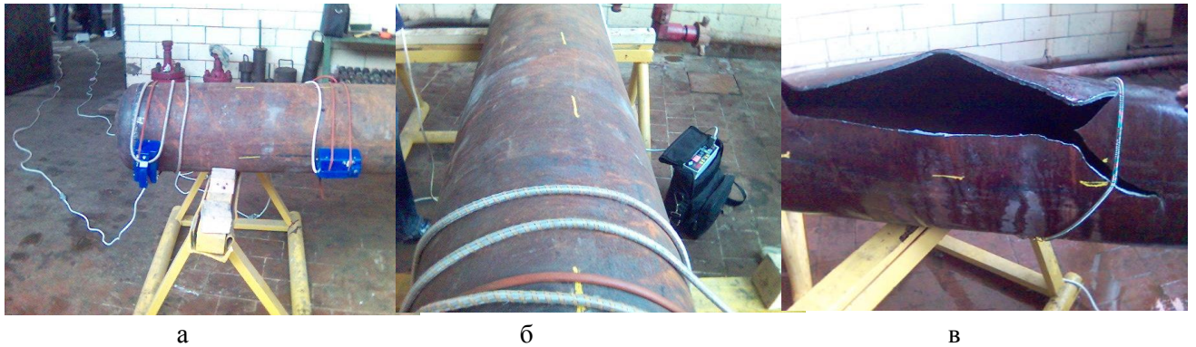
Рис.3. Руйнівні випробовування внутрішнім тиском труби (діаметр 300мм, товщина стінки 8мм, матеріал сталь 17Г1С): а – приладна база коерцитиметри КРМ-Ц-К2М; б – деформування труби при виході за зону пропорційних напружень; в – руйнування при досягненні межі міцності та вичерпання запасу пластичності матеріалу.
