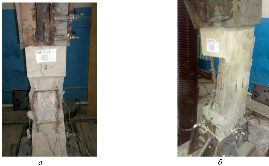
Рис. 4. Втрата стійкості оголених арматурних стрижнів. а – зразок -1-1-1; б – зразок 010.
