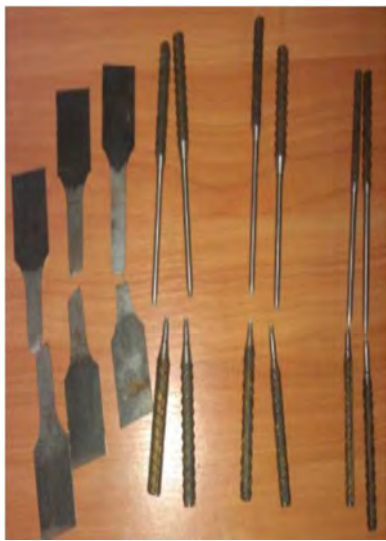
Рис. 2. Зразки для випробовування сталі
