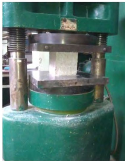
Рис. 3. Випробовування кубів розміром 150*150*150 мм
