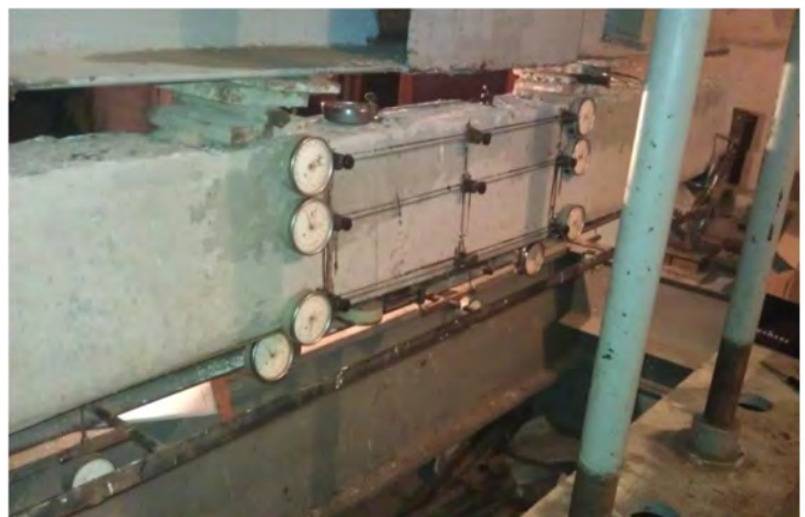
Рис. 5. Випробовувальна балка. Розміщення вимірювальних приладів
