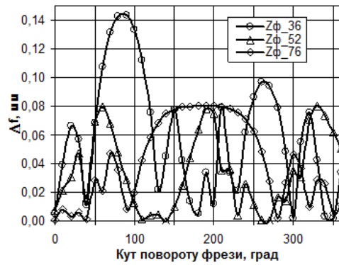
Рис. 11. Похибки профілів глобоїдного колеса від слідів інструменту в радіальній подачі від кількості зубців дискової фрези при різанні з мультиплікатором.
