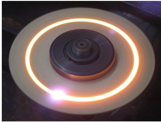
Рис. 6. Обробка диска при його обертанні з частотою 11000 об./хв.
