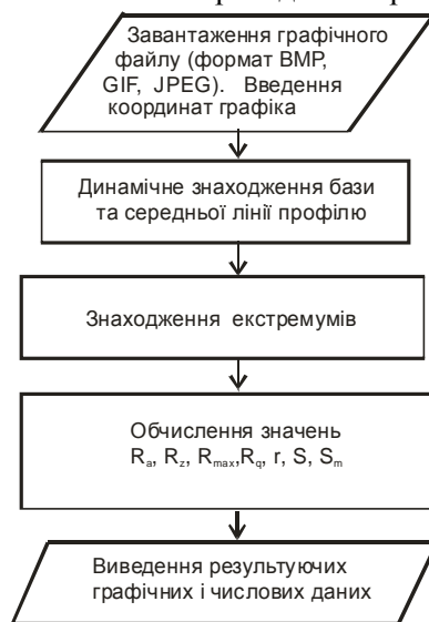
Рис. 2. Блок-схема програми Roughness Plot Analyzer для опрацювання профілограм поверхні твердих тіл.
