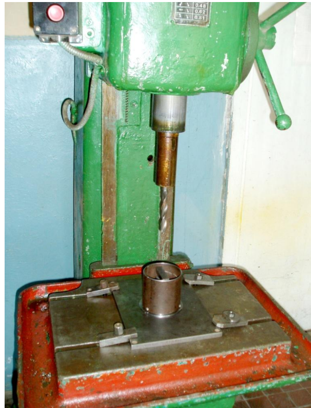
Рис. 8. Вимірний стенд (без верхньої плити) на столі вертикально-свердлильного верстату
