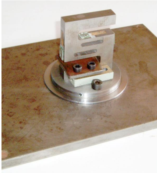
Рис. 7. Z-подібний пружний елемент з наклеєними тензорезисторами
