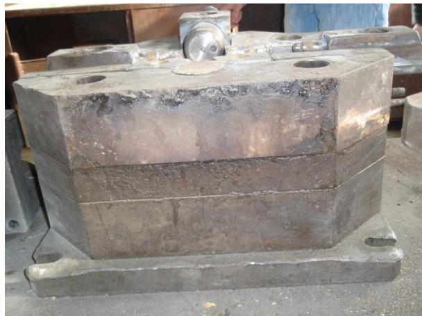
Рис.4 Форма для лиття водолічильника крильчатого KB-1.5, яка використовується на ПАТ «Електротермометрія» (м.Луцьк, Україна)
