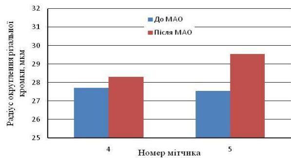
Рис.4. Радіуси округлення різальних кромки мітчиків при p=25^\circ , q=25^\circ .
