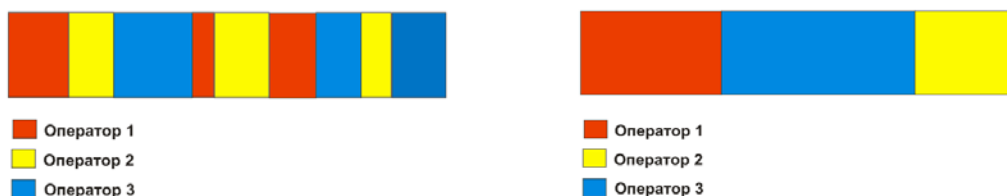
Рис. 5. Перерозподіл частот з метою виділення широких смуг
