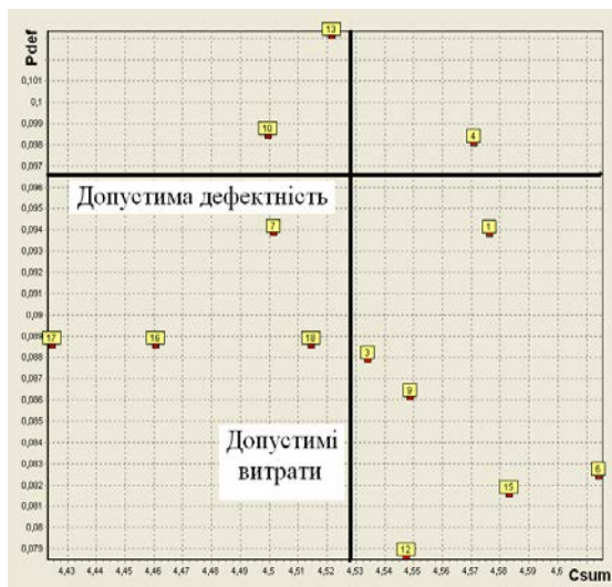
Рис. 3. Приклад оптимізації 6-ти крокового ТП виготовлення друкованих плат: а – варіант протоколу дослідження; б – оптимізаційна Парето-площина ”сумарні витрати – вихідна дефектність”
