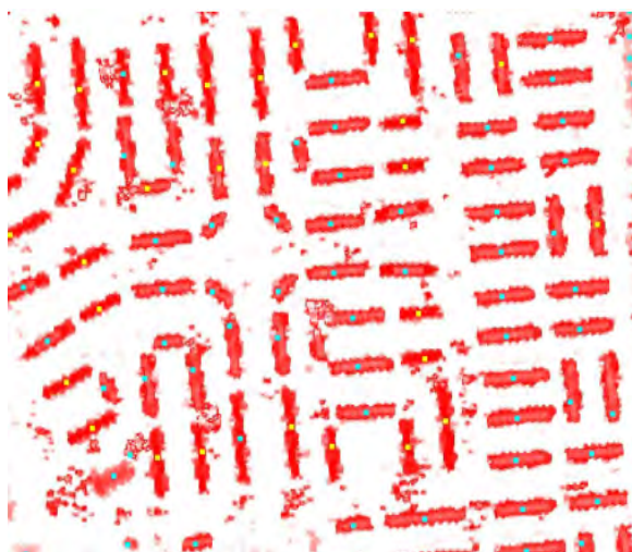
Рис. 2. Растрове зображення, отримане з лазерного сканування, та центроїди будівель
