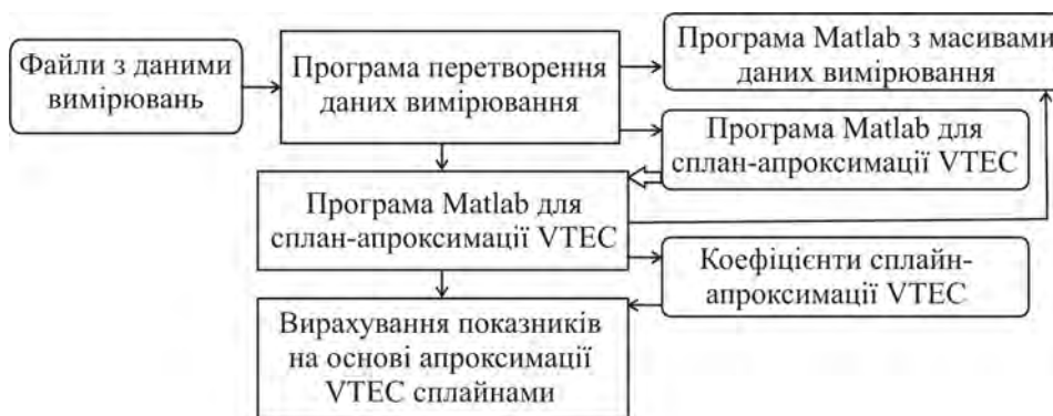
Рис. 1. Схема програмного забезпечення визначення VTEC як функції часу
