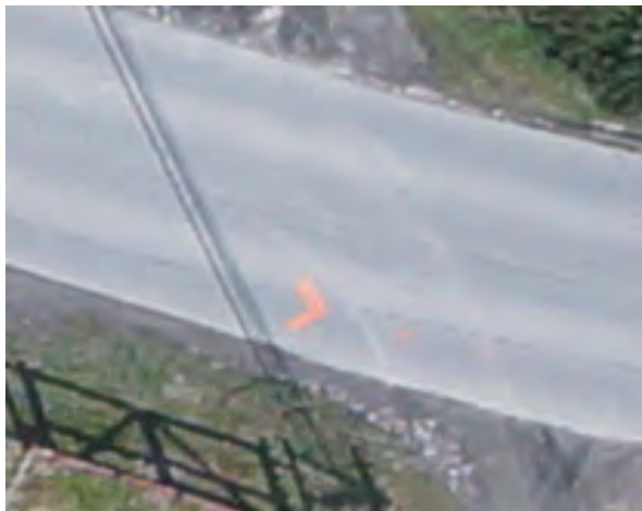
Рис. 2. Видгляд розпізнавальних знаків намальованих на поверхні (аерознімання з БПЛА UX5, H = 150 м): а – кутподібний, б – хрестоподібний Fig. 2. Marking drawn on the surface (aerial imaging from UAV UX5, H = 150 m): a – angle-shaped, b – cross-shaped
