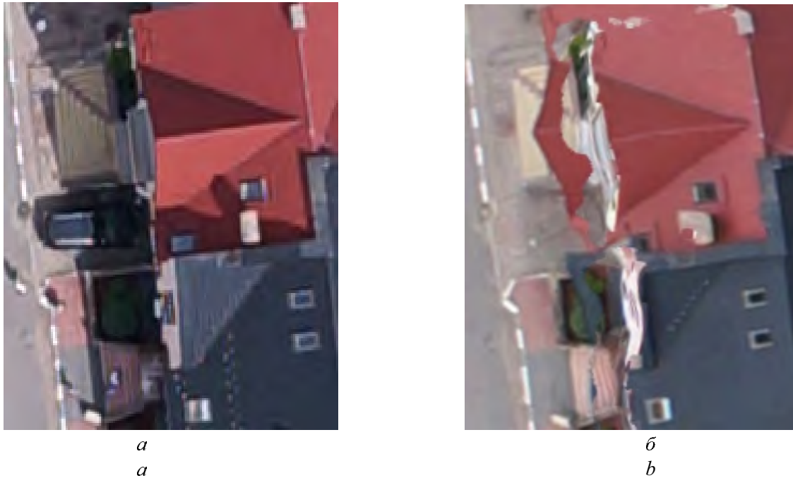
Рис. 13. Спотворення контурів на ортофотоплані: а – зображення на цифровому знімку; б – зображення на ортофотоплані
