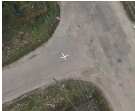
Рис. 2. Видгляд розпізнавальних знаків намальованих на поверхні (аерознімання з БПЛА UX5, H = 150 м): а – кутподібний, б – хрестоподібний Fig. 2. Marking drawn on the surface (aerial imaging from UAV UX5, H = 150 m): a – angle-shaped, b – cross-shaped
