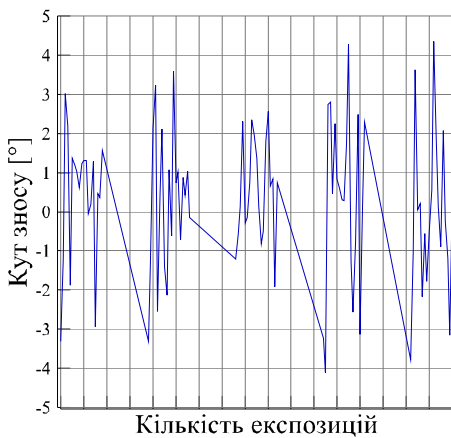
Рис. 11. Зміна кутів зносу в момент експозицій (курс 1°) Fig. 11. Drift angle changes at exposure times (heading 1°)
