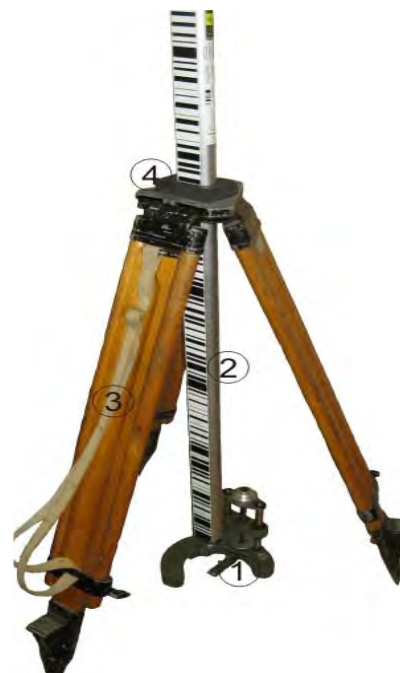
Рис. 2. Рейка на підйомному механізмі: 1 – підйомний механізм; 2 – штрихкодowa рейка; 3 – штатив; 4 – фіксатор штрихкодowoї рейки
