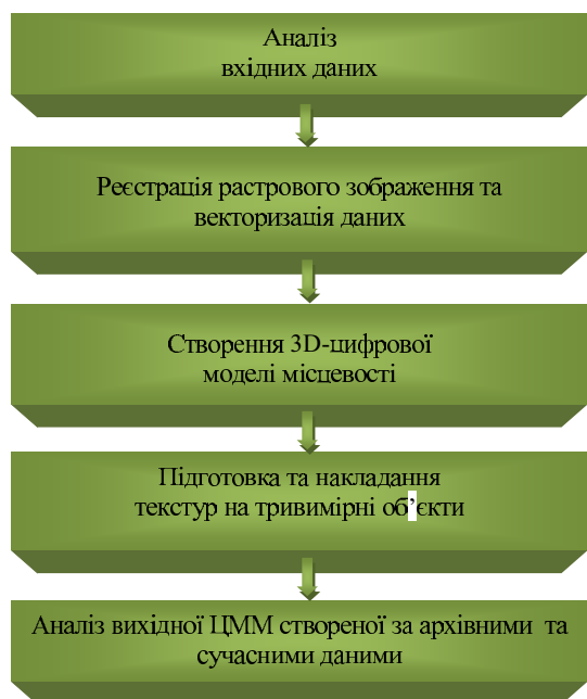
Рис. 2. Технологічна схема створення ЦММ ансамблю оборонних споруд "Цитадель" Fig. 2. Technological scheme of DTM creation for ensemble of architectural constructions "Citadel"
