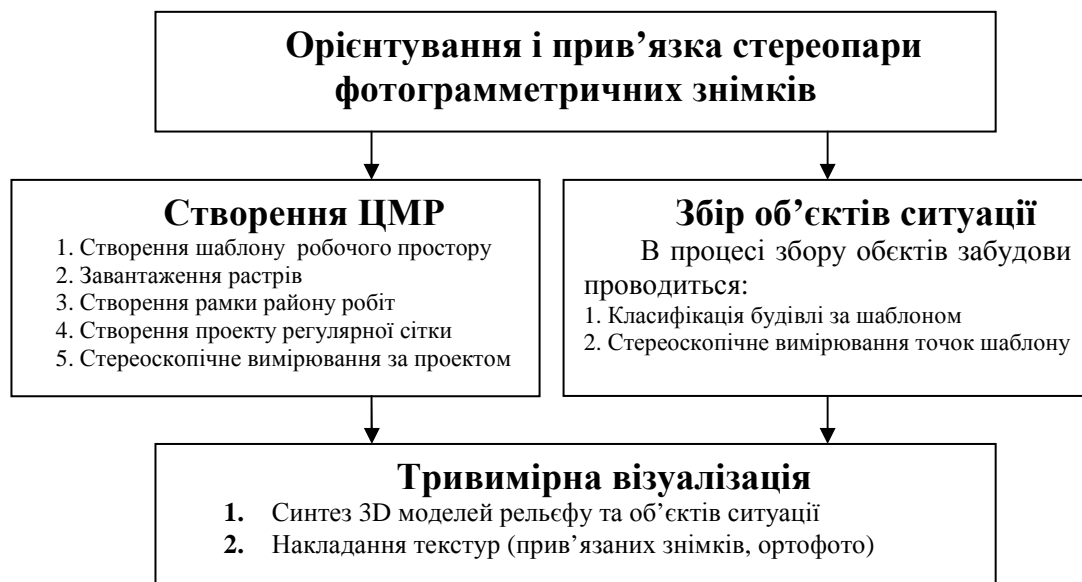
Мал. 1. Технологічна схема підготовки даних та тривимірного моделювання місцевості у ПП Digital
