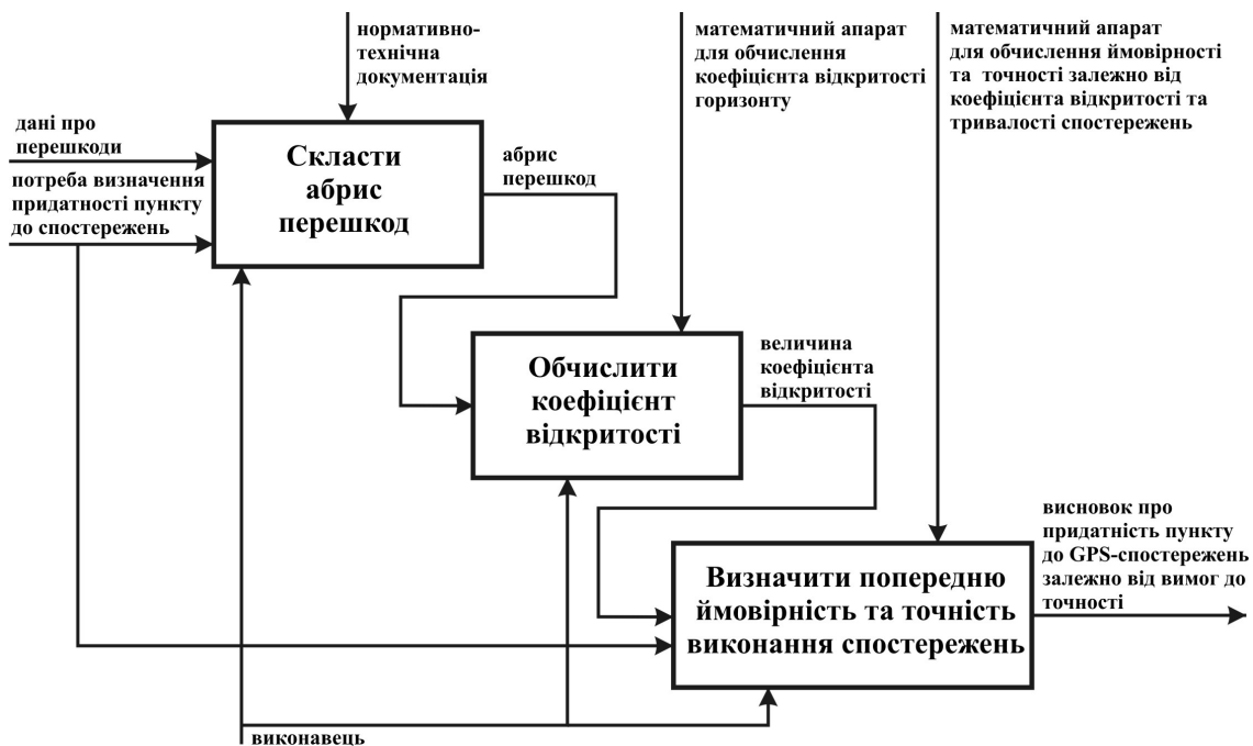
Рис. 5. Модель IDEF0 визначення придатності пункту до GPS-спостережень
