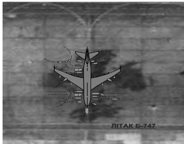
Рис. 2. Представлення процесу деталізованого розташування та пересування обслуговувального транспорту на прикладі Boeing-747
