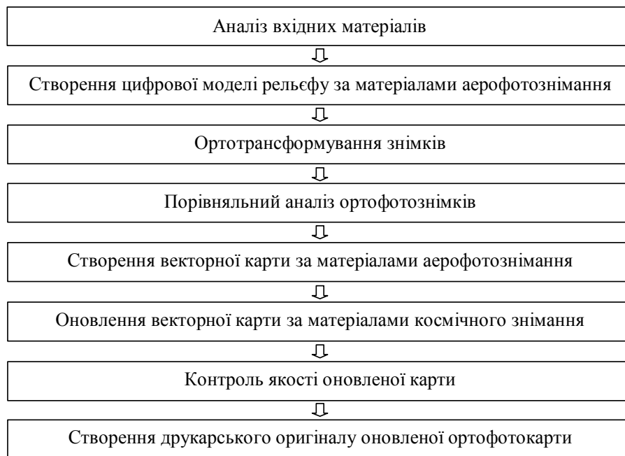
Рис.1. Загальна технологічна схема створення та оновлення топографічної карти за матеріалами аерокосмічного знімання
