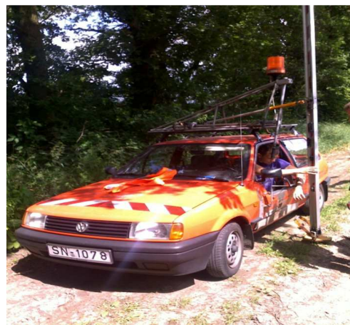
Рис. 4. Встановлення рейки на башмак безпосередньо з автомобіля
