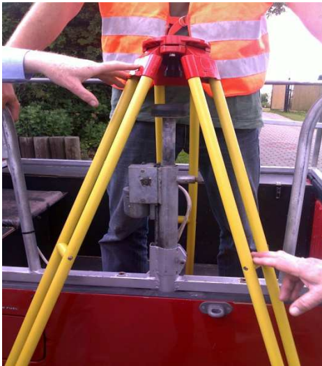
Рис. 5. Механізм для піднімання та опускання приладу
