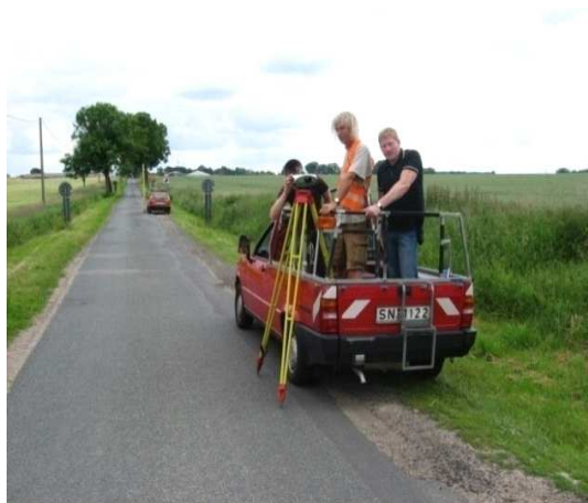
Рис. 3. Вимірювання перевищення між станціями
