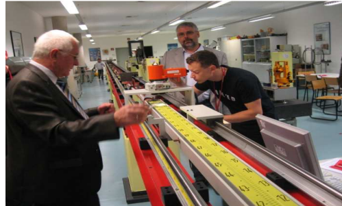
Рис. 10. Принцип роботи механічного компаратора Рис. 11. Встановлення рейки в механічний компаратор
