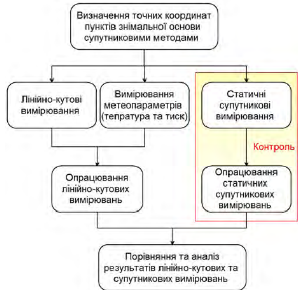
Рис. 2. Алгоритм для проведення дослідження добового руху референцної ГНСС-станції BRGN Fig. 2. Algorithm of investigation of daily movement of BRGN GNSS reference station
